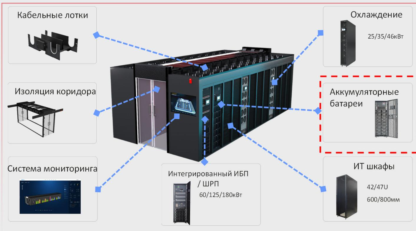
Модульный ЦОД призван предоставить заказчику простое, надежное и эффективное решение, которое гарантирует бесперебойное функционирование необходимых сервисов и удобное обслуживание. Высокая заводская готовность и интеграция оборудования обеспечивает быстрое развертывание комплекса инженерных систем. Каждый модульный ЦОД включает в себя системы электропитания, охлаждения, мониторинга, систему шкафов и изоляции коридора, а также кабельную систему.
